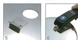
テーブルなどの端に置きます。ふたの取っ手をふたについているフック(写真⑤)に引っかけ(写真⑥)、そのままカチッと音がするまで押し下げて、取っ手をふたに固定させます。ゴムパッキンもふたの縁の内側にきちんとめ込みます。
