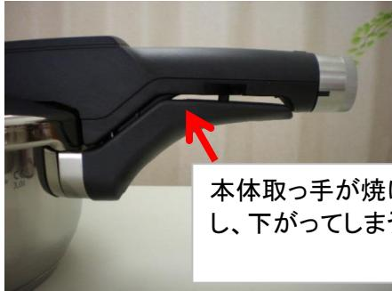
本体取っ手が焼けて変形し、下がってしまうと隙間
